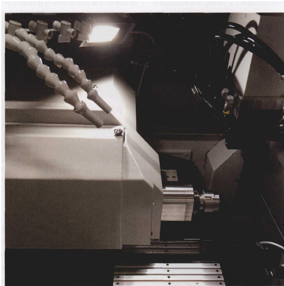
图 1 Cincom L12 型 VII 瑞士型车削中心可以以“可转换”的模式来运行，这意味着可以移除导向衬套，以便可以加工更宽直径的棒料，只要长度直径比小于 3:1 即可
