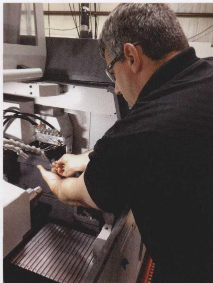
图 4 Darryl Sienicki 是瑞士苏黎世电气公司购买新瑞士型车床的项目高级工装设计师和负责人，此处展示在 10 线高雅冷却系统中调整喷嘴
