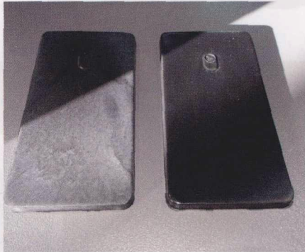
图 3 左边为传统方式生产的产品，右边为快速加热与制冷工序生产的产品
