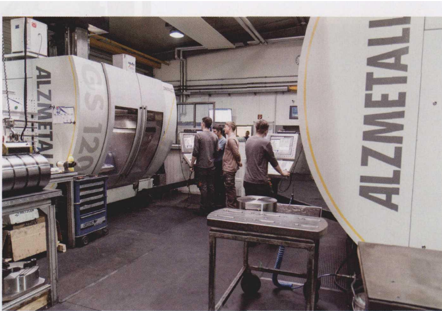
在这里能看到车削与铣削的完美结合。两台配海德汉 TNC 640 的全新 Alzmetall GS 1200/5 FDT 加工中心
