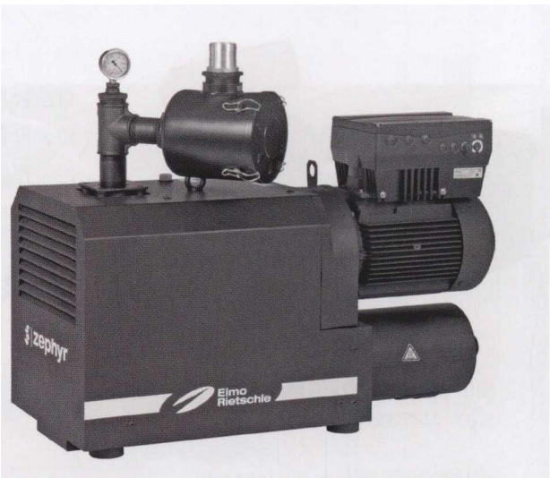
图 3 装有频率调节的 IE3 发动机的 C-VLR 301 型极限真空泵每小时抽气能力为 370 m 3 ，在持续作业中极限真空压为 200 mbar，通过采用发声技术能明显降低音辐射压
