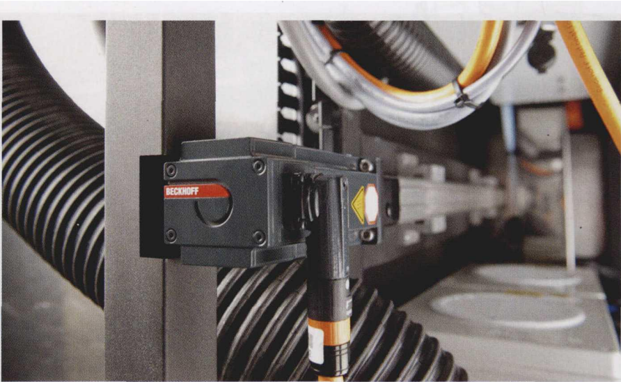
图 3 涂料机装配的伺服马达采用 OCT 技术，由此节省了安装空间
