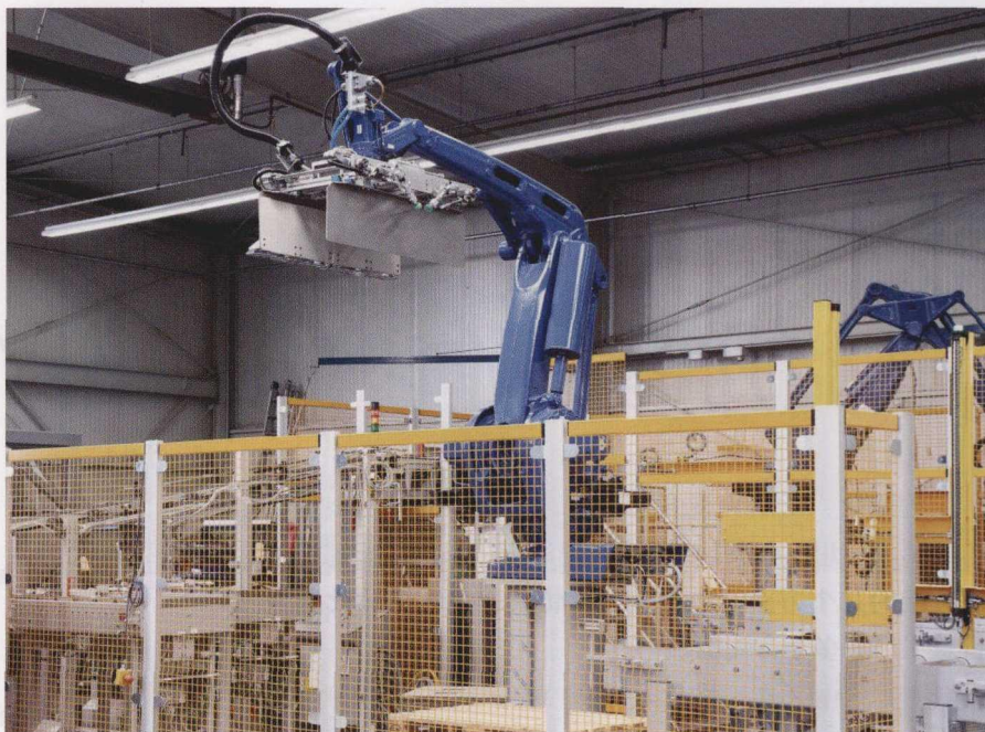
空间的最优利用：该堆码系统组成了一条高度自动化包装线的末段
