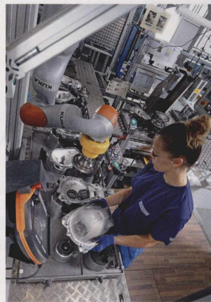
图2 人和机器人合作,共同将所有零件放进传动装置壳体内,部件通过输送装置的上方自动抵达该人-机器人-合作(MRK)作业单元并由一名作业人员进行准备工作
