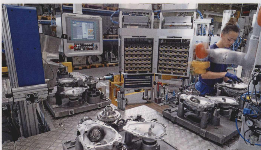
图1 在该人-机器人-合作(MRK)作业单元工作的作业人员与机器人在狭窄的空间内携手作业,不需要安全围栏
