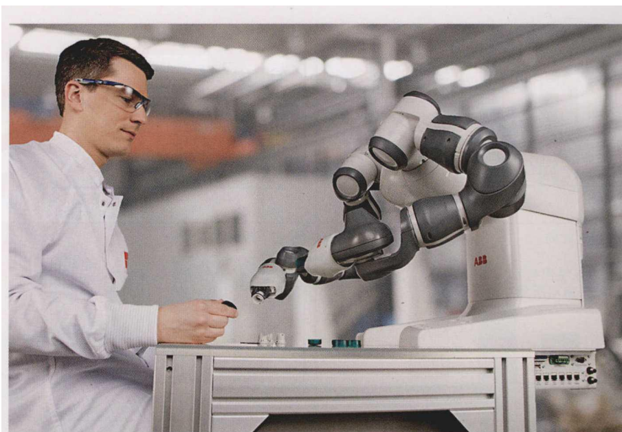
图 1 在该应用中，一部自重轻的机器人作为“第 3 只手”以受限的扭矩和适合的速度运动
