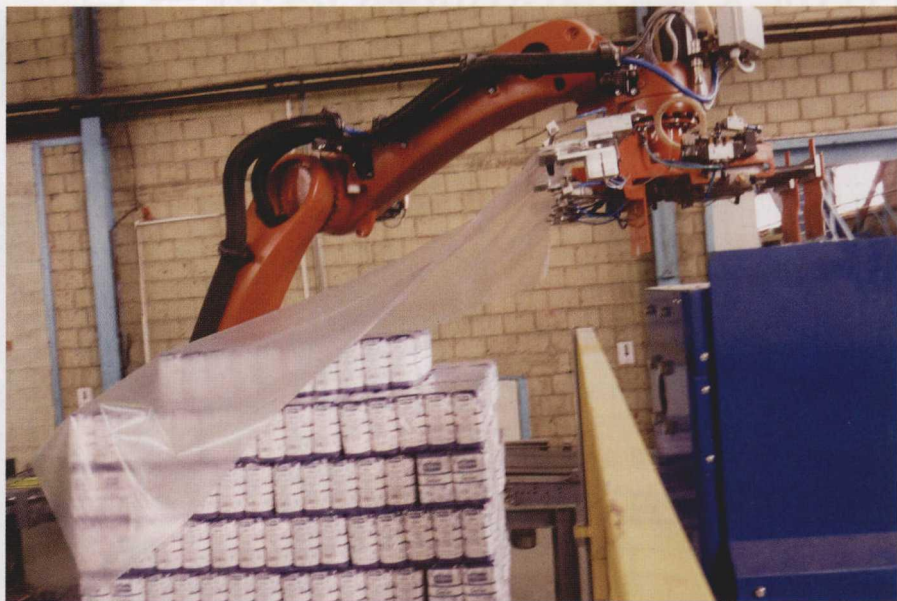
图 2 这一包装单元利用滚动式传送系统将包在热塑薄膜里的 10 包 1 kg 装的糖果运送、码垛在欧洲标准货盘上，再用塑料膜包好以备运送
