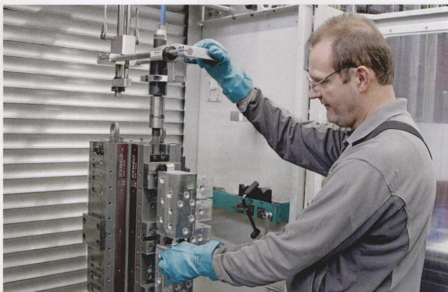
图 1 在两个换装和转载工位上设有可提高人体舒适度和夹持安全性的操作系统
