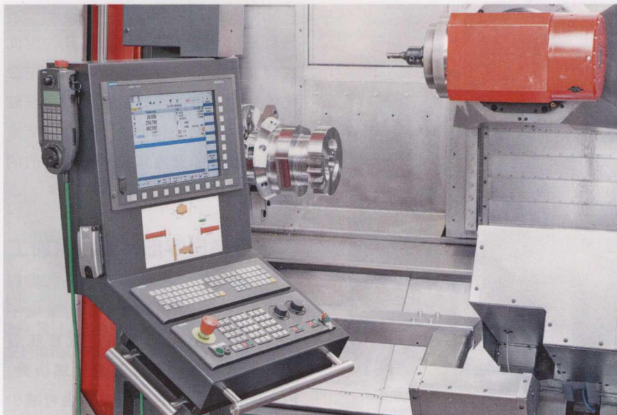
Multicut 系列机床均采用西门子公司 Sinumerik 840D sl 控制系统来控制
