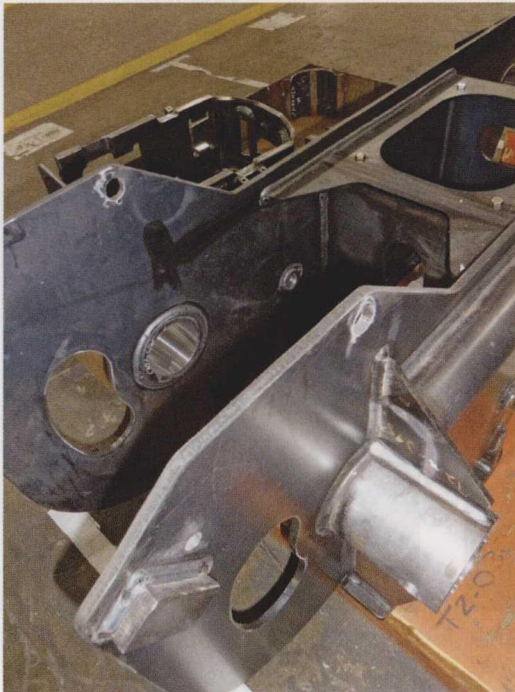
图2 左侧的工件被称作后部子焊接件或“替代件”，并且其承载了悬臂重量及其负载的大部分
