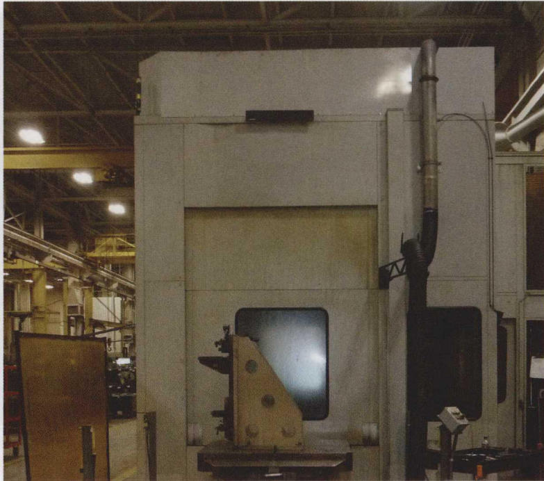
图3 在购买 Burkhardt + Weber 之前，Link-Belt 使用这台卧式镗铣床来生产悬臂部件，虽然它运行出色已有多多年，但是是一个需要面临的问题就是：由于其托盘加载，使其处于闲置状态
