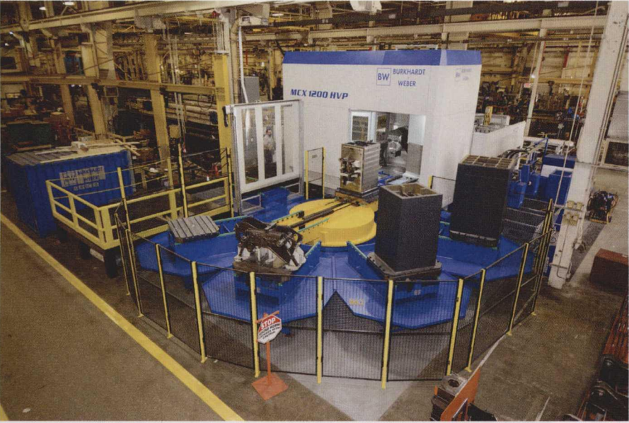
图 4 用于零件自动装载 / 卸载的六托盘站可实现熄灯加工，该配置可携带 30 个零件；每个多零件加工模块上有五个零件，使用四侧面和顶部用于第五工件
