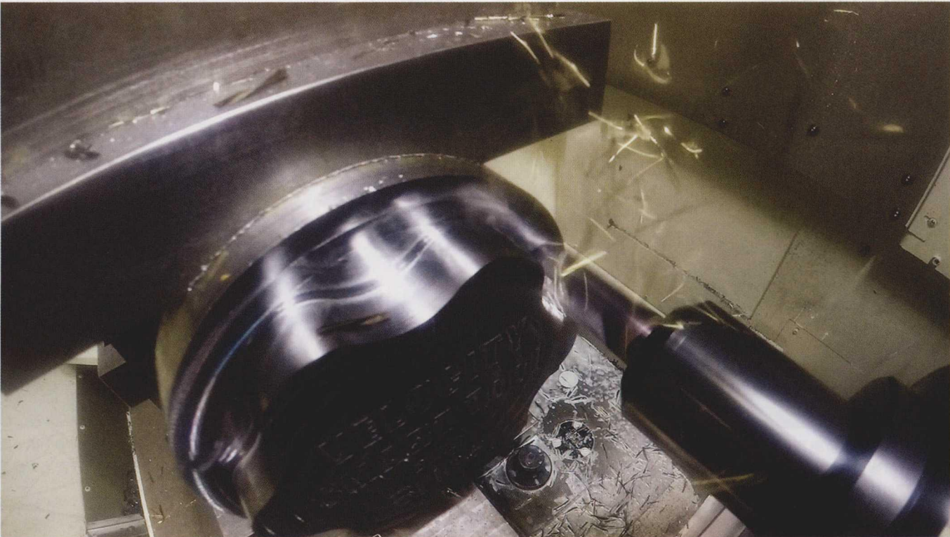
轴的转速随给定的机床工具组合系统的频率响应而变化，可以使用更重、更平滑、产量更高的铣刀。智能工具系统包括工具 / 工具支架结构，针对特殊加工中心使用进行了优化，所以系统内的铣刀可以在相应机床上尽可能发挥最大作用
