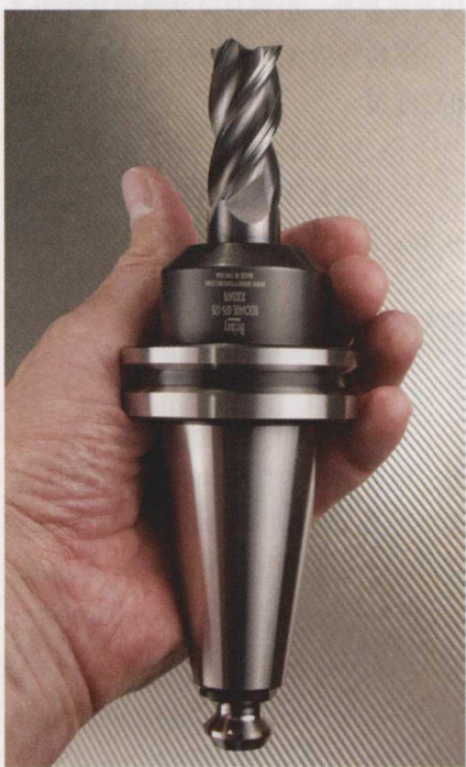
图1 工具支架、工具和固定把手开始运输之前已经完成组装，并预先调平衡。工具上设置固定螺丝孔来确保具有足够的伸出长度，以便进行动态优化
