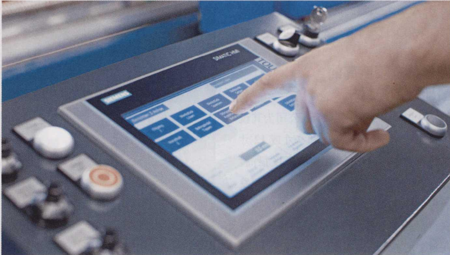
图 2 Tibo 公司在其系列设备上均配有 PLC（可编程控制器），并配置 9 in 或 12 in 触摸式面板
