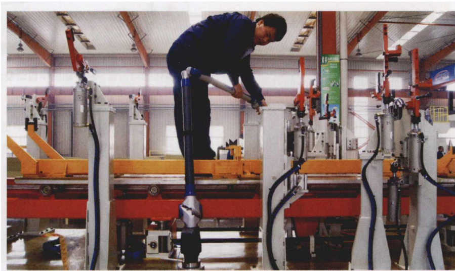
工作人员正在应用 FARO Prime 对 7 m 夹具进行检测
