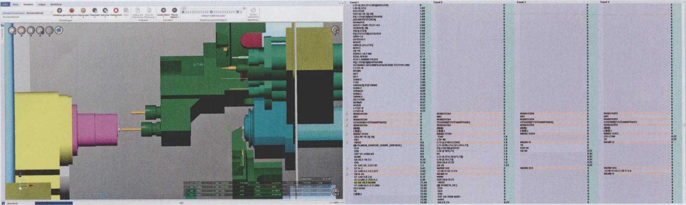
图 2 关键的一点是采用 NC-Simul Machine 可以直接在 NC 代码上进行模拟。由此，CAM 编程人员直接对 NC 代码的干涉自由度进行检查，并得出加工路径和加工时间
