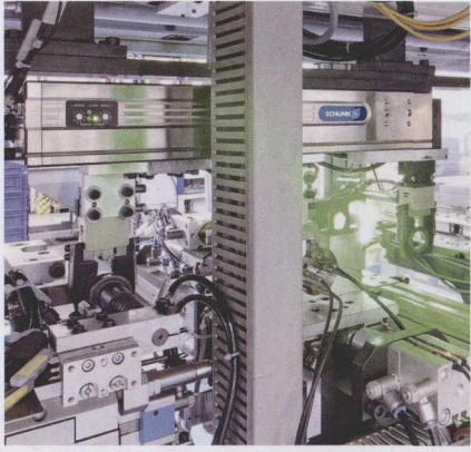
图 3 SCHUNK（雄克）ELP 直接驱动式线性轴取代了气动模块。大幅减少了振动和组件的磨损，并缩短循环时间
