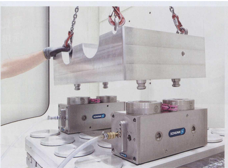
图 1 SCHUNK（雄克）VERO-S 系统的直接夹持概念在机械工程中的重要性越来越强，例如本文所述的改装
