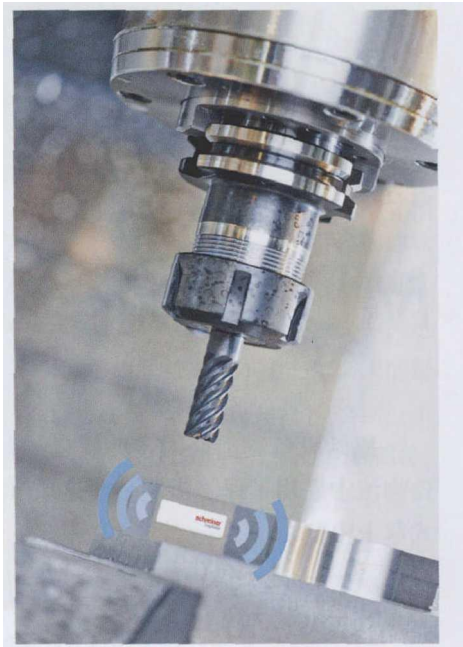
图 3 在切削加工工业企业中也可以使用 RFID 射频标签
