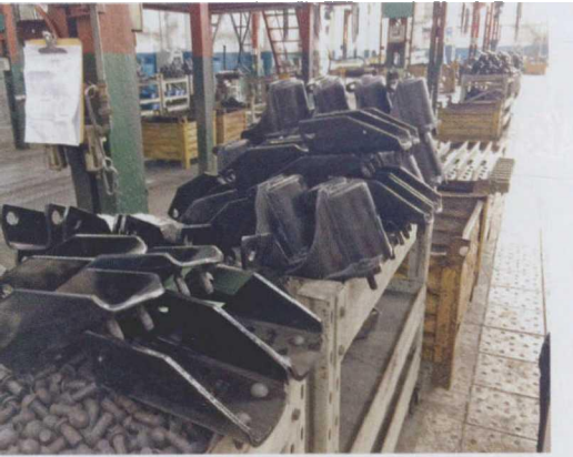
图2 根据备件的大小、形状和重量，它们被分别放置在有着不同读取性能的容器中，由移动式终端设备读取备件数据
