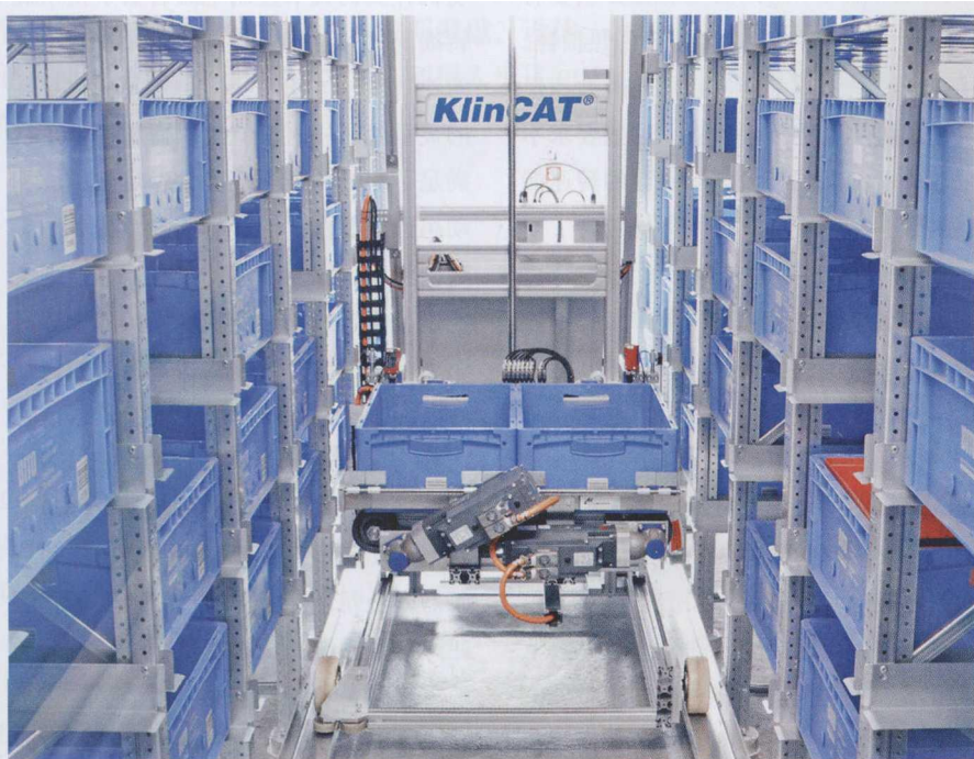
Klincat 仓库专用设备是将货架操作设备和往返运输工具综合到一起的穿梭式多层往返运输装置
