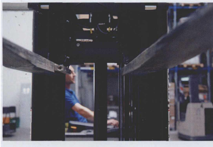
图 2 为使叉车驾驶员能够清楚的看到高度 15 m 的货架架口中的情况，所有叉车的叉杆处都配备了一台微型摄像机
