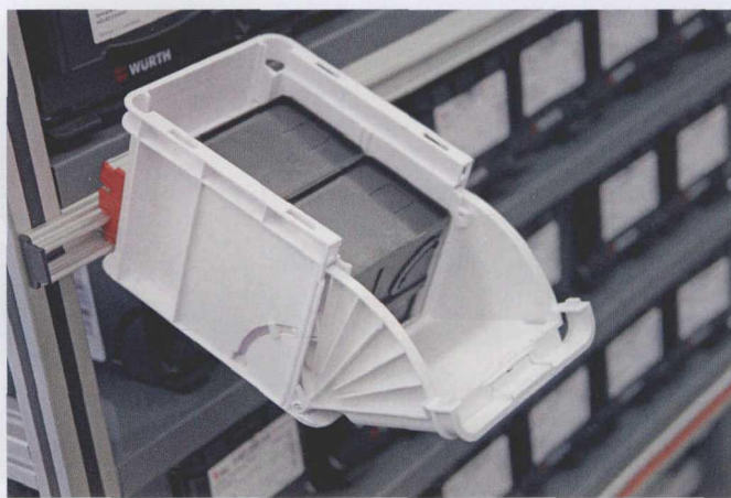
图3 它与 Würth 公司以前的 VDA 标准的 W-KLT 2.0 小件周转箱兼容，应能优化生产中的工作流程
