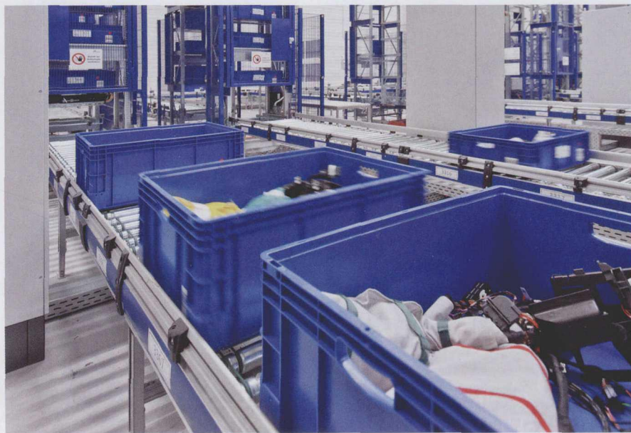
图 4 Imperial 物流公司利用一座自动化的准时化顺序供应仓库为德国北部的一家汽车生产厂装配线提供电缆束
