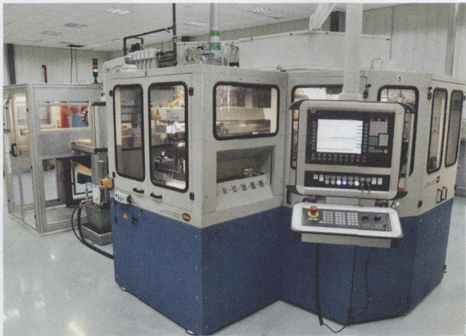
图 2 Sinumerik 840D SI 被用作跨技术的总体数控装置，在不同站点可以根据用户的要求进行铣、钻和车削加工
