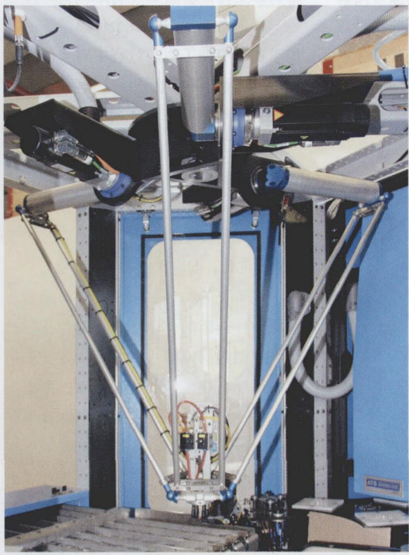
图 1 借助伺服电机 AM30xx 和平板电脑 CP6203 实现了 Delta 机器人的动态构造，使得测试单元中的测试过程更加快捷和精确
