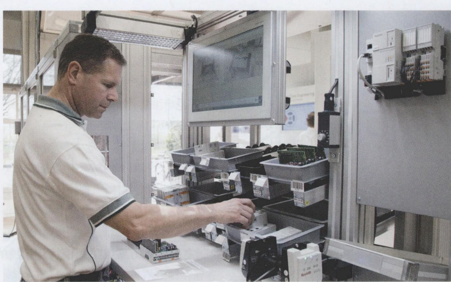
图 2 辅助系统 Activeassist 帮助工人进行各种手工作业安装
