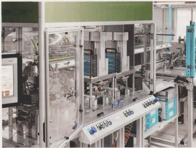
图2 保证高精准性灵活性及可靠性的插针生产线
