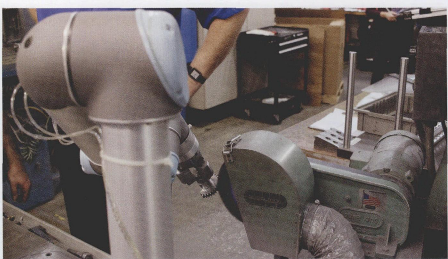
图 3 Task Force Tips 的移动 UR5 机器人正在进行去毛刺应用试验
