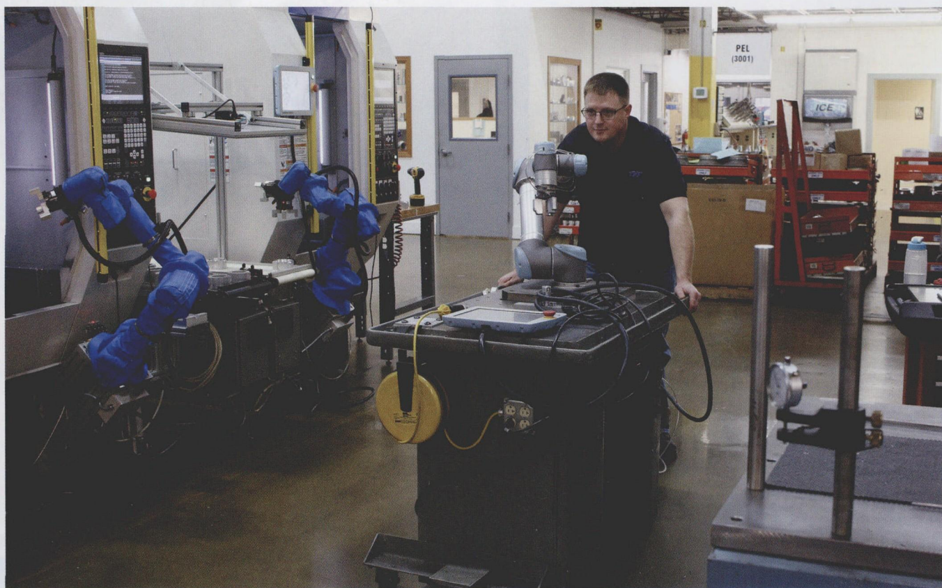
优傲机器人生产的机器人可以更加灵活地进行自动操作，还能每天进行变更。Task Force Tips 公司在带轮的工作台上安装了一个 UR5 机器人，让机器人在车间的不同任务之间移动
