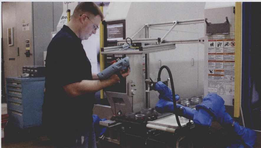
图1 自动化专家 Adam Hessling 说，它可以打开优傲机器人公司的控制系统，教机器人一些基本的转向点，在几分钟内就可以创建一个很基础的程序
