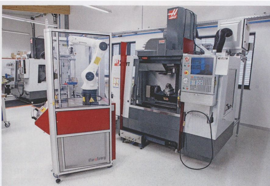
图3 可行走的机器人工作站拥有轻型滚轮，因此可以依靠简单的人工操作被转移到下一个应用区域里并接受安装和开机
