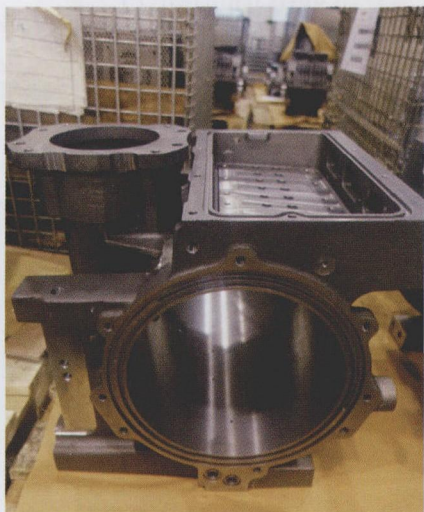
图 2 用山高刀具加工的零件表面光洁
