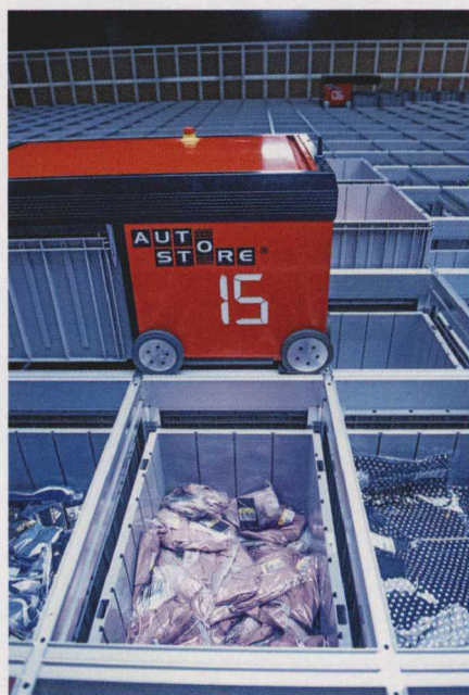
图 3 与传统的分拣配货相比较，AutoStore 系统可以在相同的空间内多存储 400% 的物资。同时也缩短了调货时间、降低了能源费用、提高了安全可靠性
