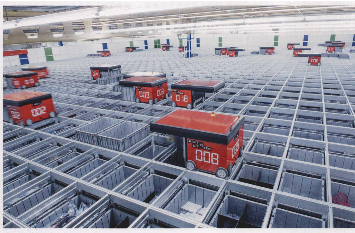
图 1 像 AutoStore 这样的柔性、模块化的自动化存储解决方案可以规模化扩展和优化，以便保证满足存储的需求和要求。同时也奠定了未来增长的坚实基础
