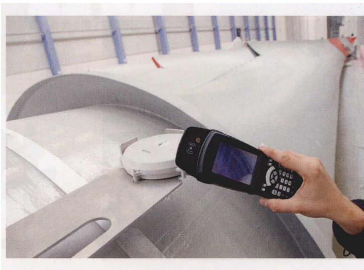
图1 马格德堡市霍伦霍夫 IFF 研究所的物流技术专家与 Enercon 公司合作开发了适合于大型零部件生产、仓储使用的自动化解决方案；这是一种基于 RFID 视频识别技术仓库管理现代化解决方案
