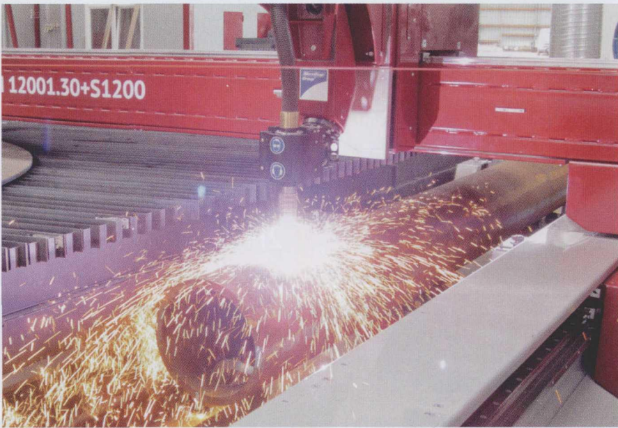
在等离子切割过程中会产生很多粉尘和烟气。一款特殊的过滤和抽烟装备可以对员工进行保护并有助于企业实现节能
