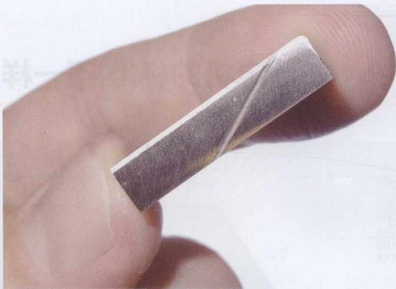
图3 一台 LMJ 机穿过陶瓷涂层，钻出该孔，这是使用电火花加工钻孔是无法实现的，因为涂层是不传导的，这种能力使涡轮叶片制造商可以在涂层之后钻孔，而不是之前，简化了整个过程
