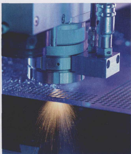
图 4 除涡轮叶片孔外，LMJ 应用范围包括从金属板上切割模板
