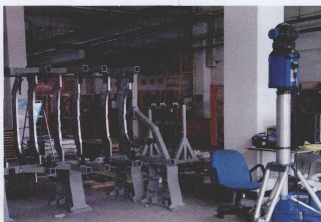
FARO Laser Tracker 应用于 LE700 小型飞机装配夹具
