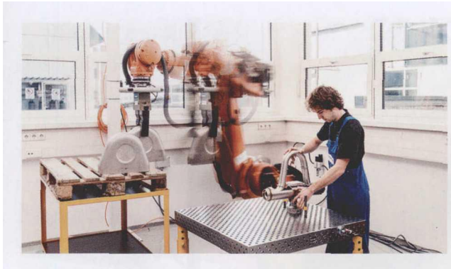
图 2 在创新试验室里，工作人员与大型机器人合作进行作业。感观上，不设置隔开的防护装置，并且使用一台重型机器人便可实现新式的适应性强的生产制造场景
