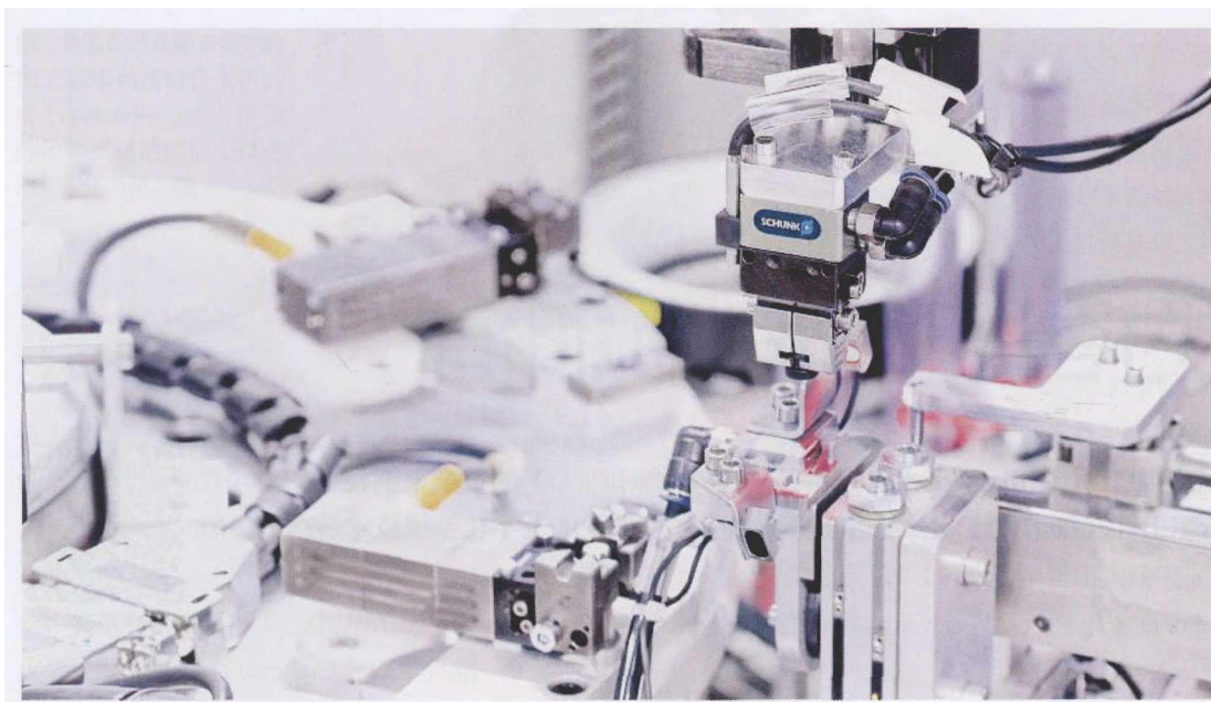
图2在第一个工作台，塑料件首先由一个气动 Schunk MPG25 来操作
