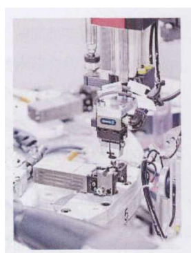
图3 协作：气动 Schunk MPG25 递交给电动 Schunk EGP25
