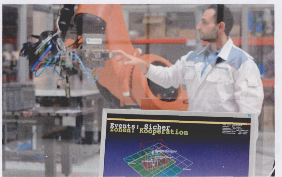
图3 德国弗劳恩霍夫研究院加工机床和成型技术研究所 (Fraunhofer-IWU) 的研发人员研制出了大型工业机器人在一个团队里安全进行合作作业的系统。设置灵活的安全区是该系统的基础：由显示器显示各个不同的安全区。在黄色安全区内，机器人和人相互合作进行作业，此时，机器人的动作大大减慢
