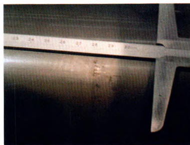
图7 镗杆氮化层脱落照片
