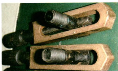
图2 磨损后的支撑爪
