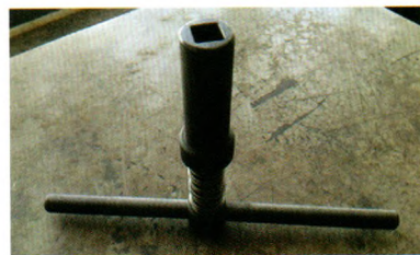
图3 弹簧弹出活动体作刀架扳手使用
