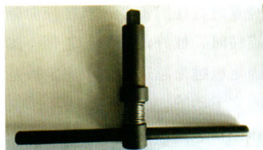
图2 弹簧压缩四方伸出作卡盘扳手用
