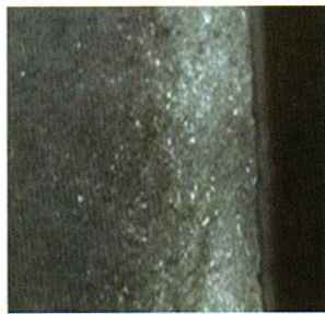
图3 溢流阀体正常表面
