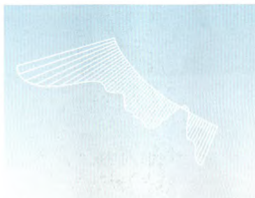
图4 I-I截面叶背样条线光顺后的曲率梳分布图
