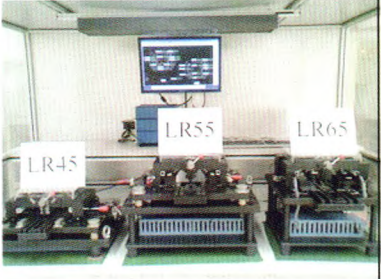
图18 LR45、55、65滚柱滑座专用自动检测装置
