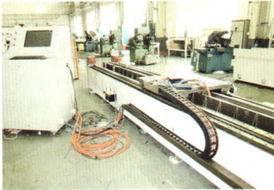
图20 JCY02检测高速重载精密滚柱直线导轨性能的装置
