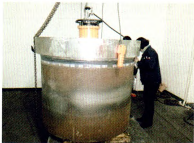
图8 焊缝射线探伤
