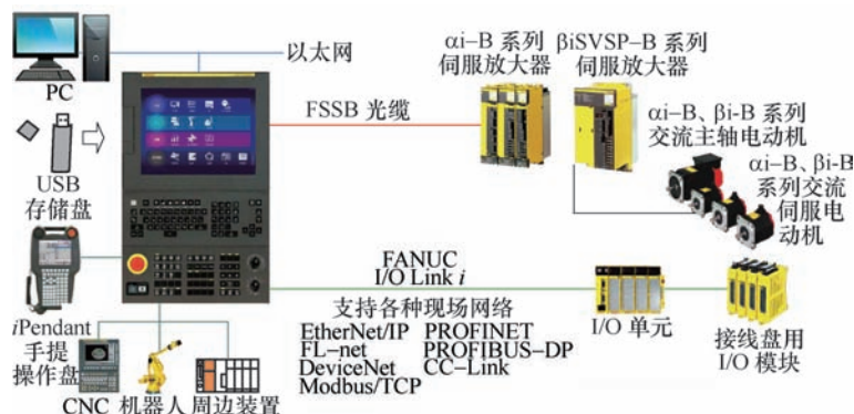
图6 FANUC 5轴加工机床的硬件链路示意图
