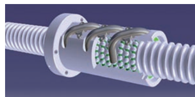
图22 高速滚珠丝杠副结构模型
