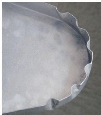
图9 侧面开槽控制起皱实例
