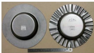
图5 冲压法兰起皱
