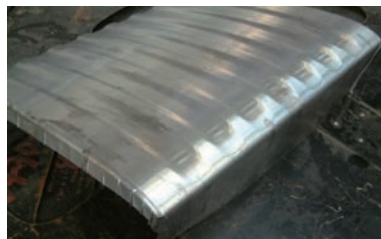
图3 零件内部起皱
