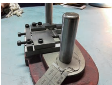
图12 新压窝装置实物
