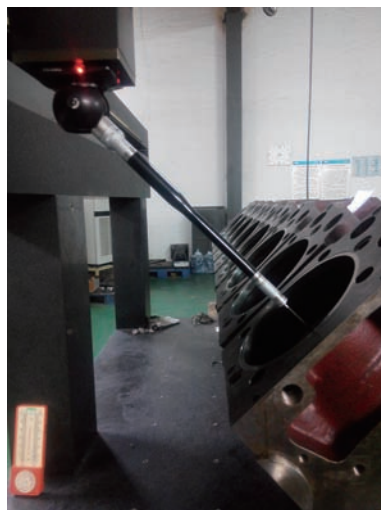
图15 测头A45B-90测量气缸孔
