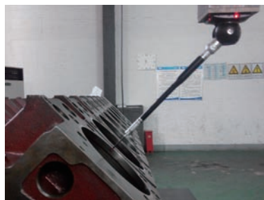
图14 测头A45B90测量气缸孔
